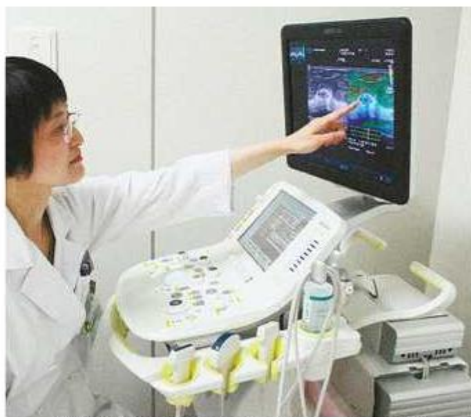
乳腺の腫瘍の硬さを色で示す機器＝名古屋市中区の中日病院で
